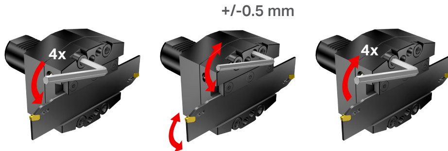
Einstellen der Mittenhöhe
